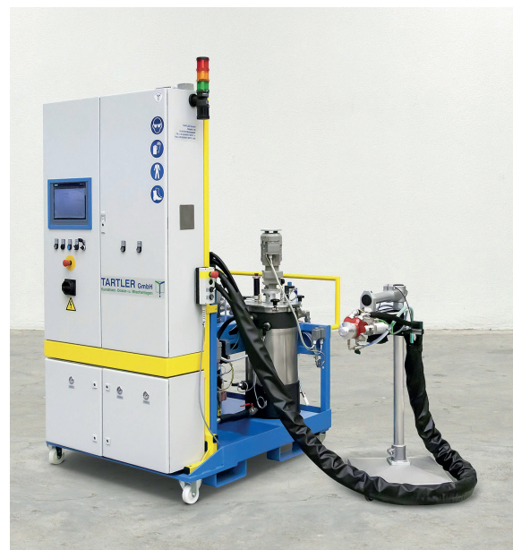
Die Kunstharz-Verarbeitungsanlage Nodopur: Bei automatisch geregelten Mischungsverhältnissen und Ausstoßen von 0,1 bis 100 l/min dosiert und mischt sie eine oder mehrere Komponenten mit Viskositäten von 1,0 bis 60 000 mPas. © Tartler Group
