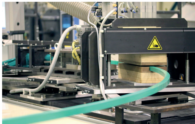
Das Ergebnis der Pultrusion ist ein leichtes, aber hoch belastbares Profil und Formteil aus GFK oder CFK. © PulNet
