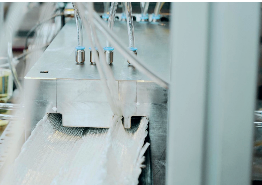
Eine der ersten Verarbeitungsstufen der Pultrusion: Einführung der Faserverstärkung in eine mit flüssigem Kunstharz gefüllte Tränkwanne oder Profilform. © PulNet
