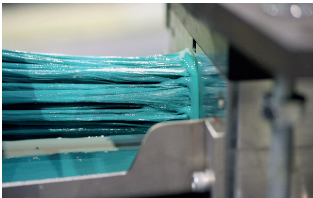
Das GFK-/CFK-Gewirk wird mit einer Matrix aus flüssigem Polyurethan (PUR) oder Epoxidharz und verschiedenen Additiven getränkt. © PulNet
